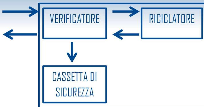
**RICICLATORE:** è un modulo in cui il sistema deposita il contante che potrà successivamente prelevare per l'erogazione del resto. Le banconote di piccolo taglio (5€, 10€, 20€, 50€) e tutte le monete vengono depositate in questo modulo.
